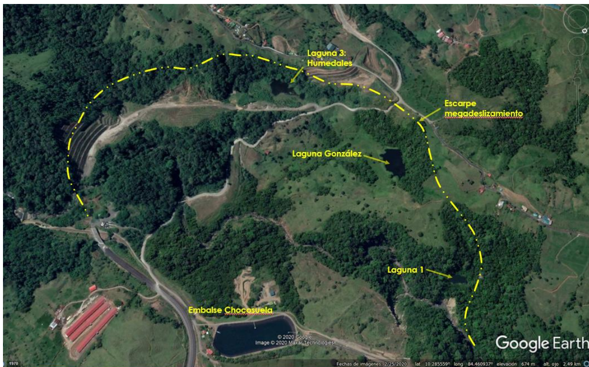
Figura 5 Lagunas que delimitan el borde inferior del escarpe del deslizamiento La Vieja.
