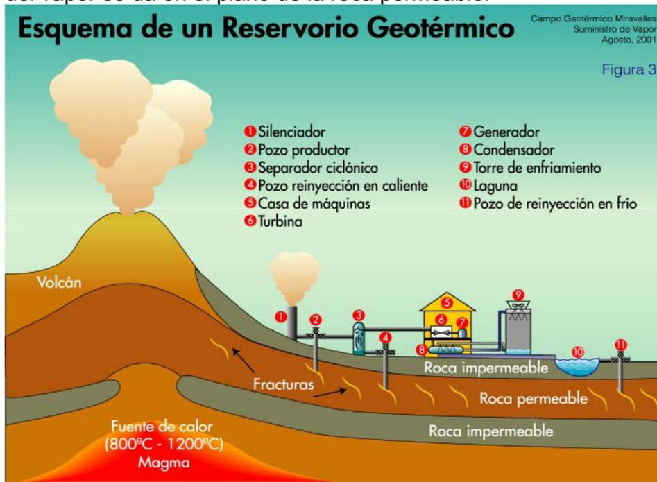
Figura N° 1 Esquema de Reservorio Geotérmico
